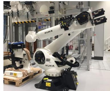
Faserspritzanlage am AZL
