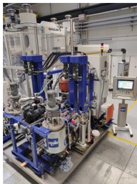
Hochdruckdosieranlage (links) und RTM-Versuchsstand (rechts, © Campus GmbH/ Moll) des AZL im Cluster Produktionstechnik auf dem RWTH Aachen Campus
