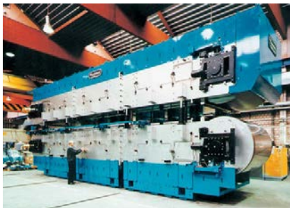
Doppelbandpresse zur Herstellung von Organoblechen [Hymmen]
