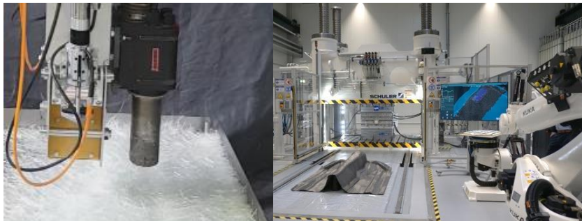
Robotergeführtes Schneidwerk für 3D- Faserspritzprozess (links). Anlagensetup am AZL mit 3D-Faserspritzern und Hochdruck-RTM-Pressen (rechts).
